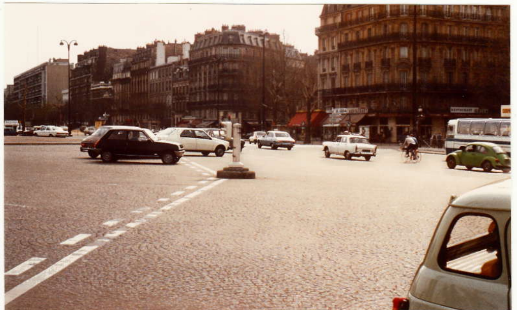
Liikennevaloristeyksen sisäinen pysähdysviiva - huomaa pienellä korokkeella oleva valopylväs opastimieen
